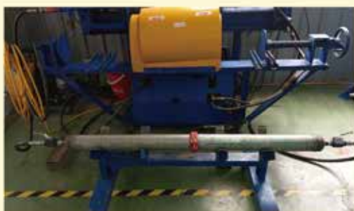
內壓循環測試
